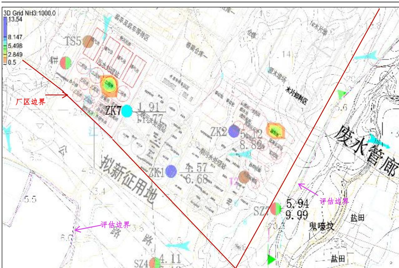
图 9.5.5-11 1000d 氨氮污染物运移预测成果图
