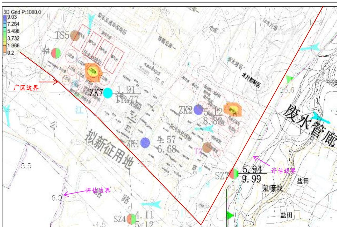
图 9.5-14 10000d 总磷污染物运移预测成果图
