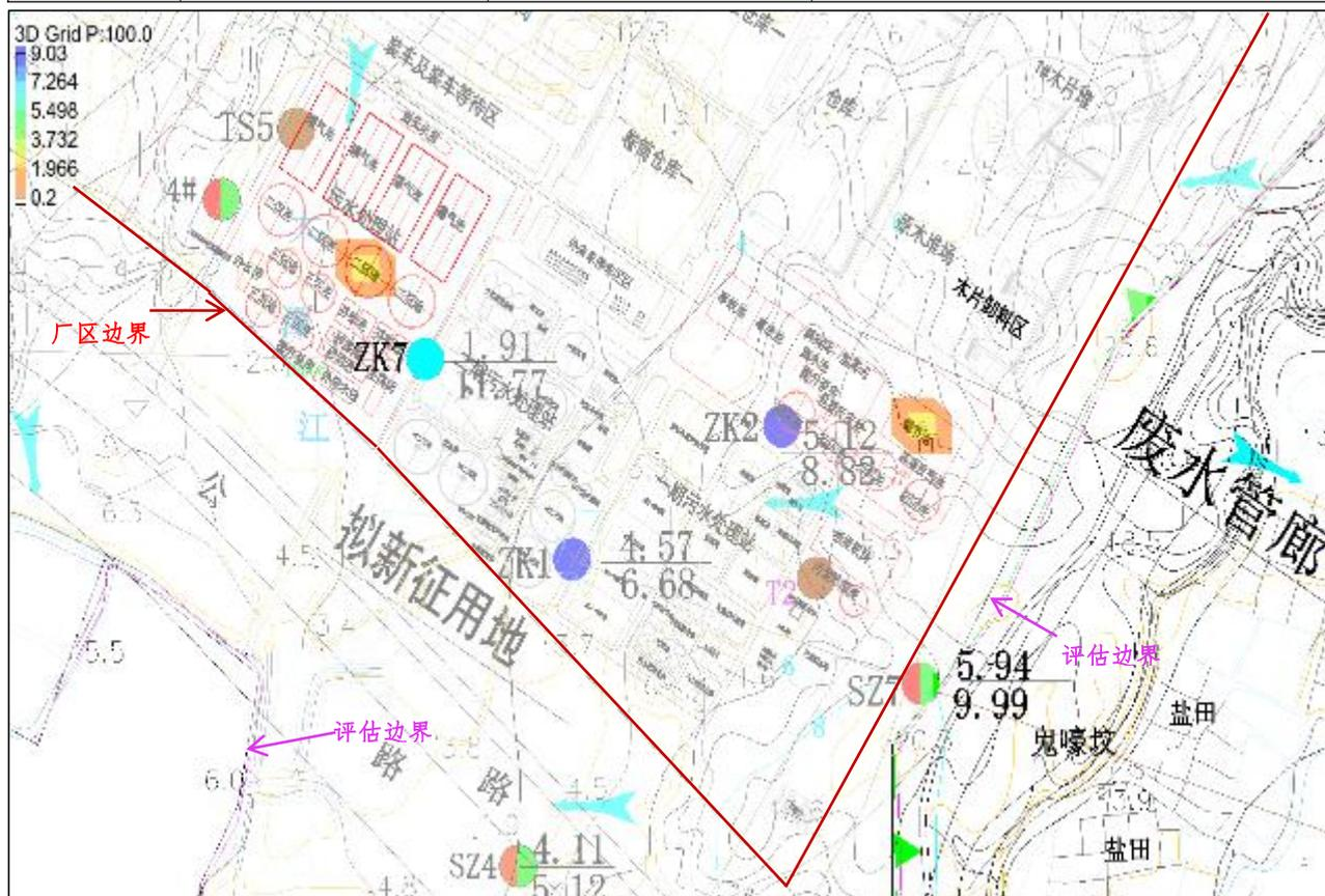
图 9.5.5-13 10000d 总磷污染物运移预测成果图
