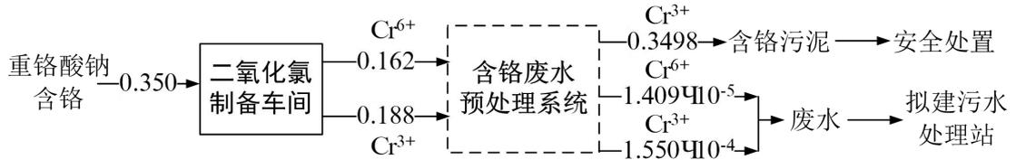
图 4.2.6 二氧化氯制备工序铬平衡 单位: t/a
